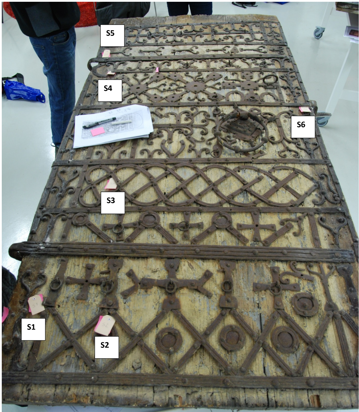
Bild 11: Föreslagna provtagningsställena för metallurgisk analys. Prov S 1 utgick ur provtagningen av antikvariska skäl.
