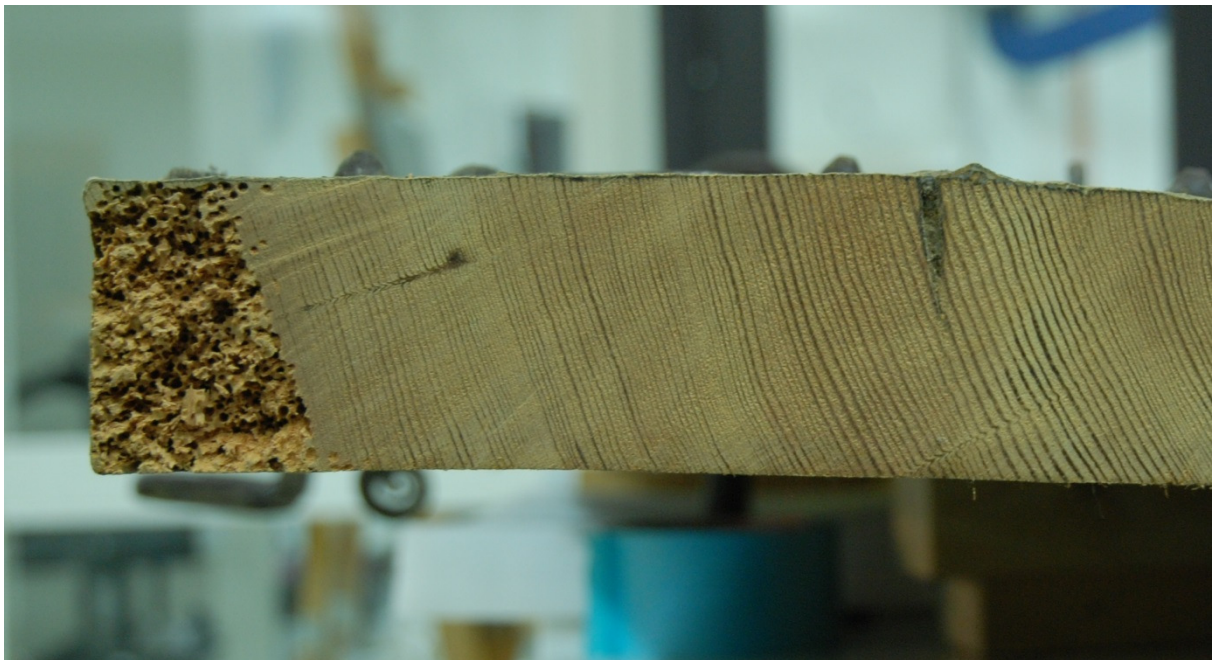
Bild 10: Samma ställe som bilden ovan, efter att 2 cm av den yttre delen av plankan sågats bort för dendrokronologisk analys. Materialet är tätvuxet, friskt kärnvirke av furu fram till splinten, som är hårt angripen av trägnagande insekter.
