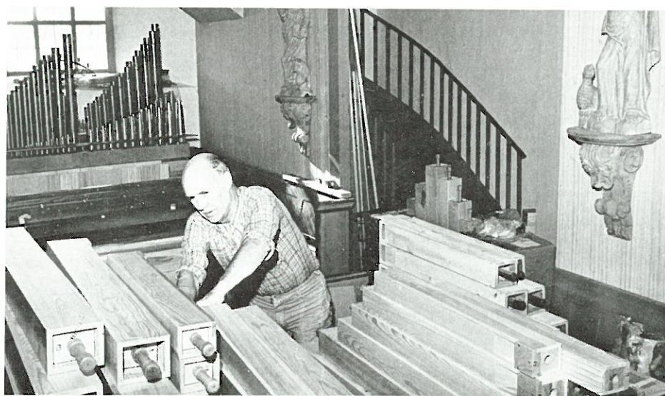
Nedre delen av kyrkan har förvandlats till orgelbyggarverkstad. Här packar Åke Karlsson upp ett lass träpipor. Det är Kvinta 10 2/3, en pedalstämma som ger fyllig och mörk baslang.
