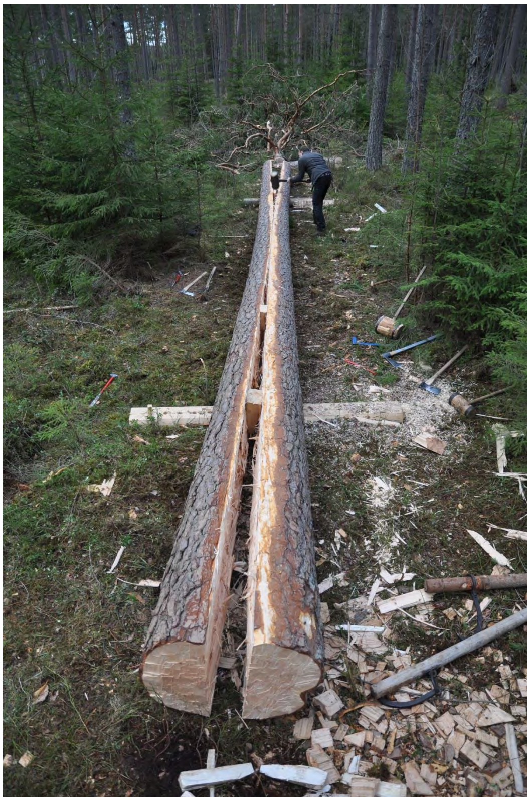
Försöket att borra av fibrerna visade sig fungera bra, och klyvningen kunde fortsätta både från rot och topp, för att sedan mötas på mitten.
