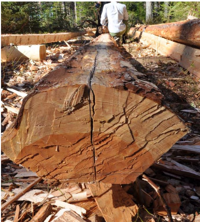
Klyvning från fjärdedelar till åttondelar
