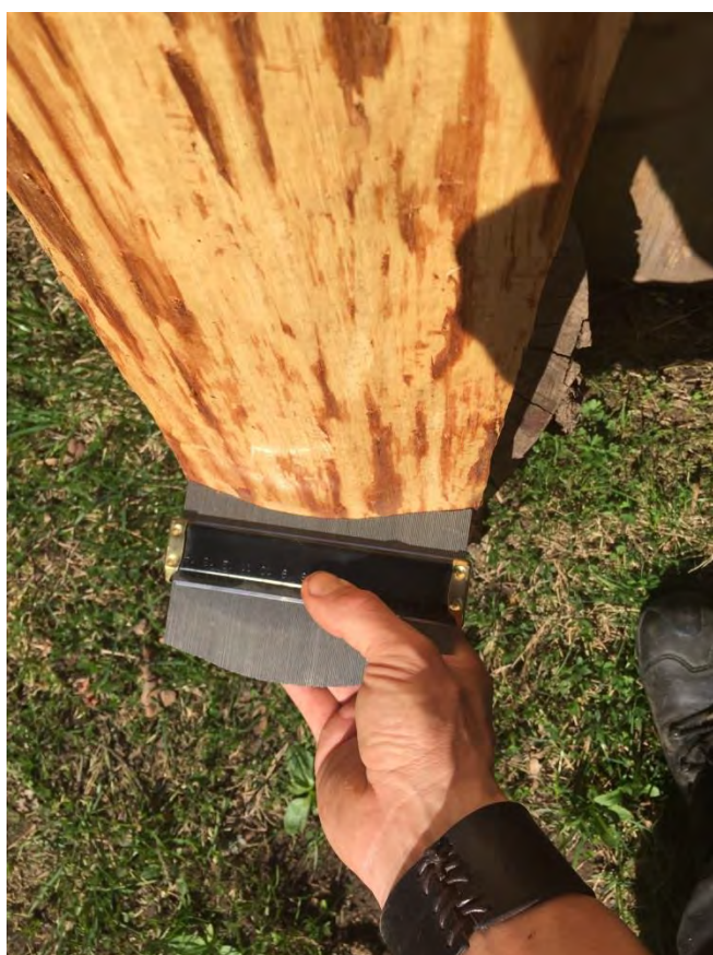
En profilmall användes för att få fram en ungefärlig radie på sparrarna i tornhuven. Bilden är ej från tornhuven, den visar endast ett exempel.
