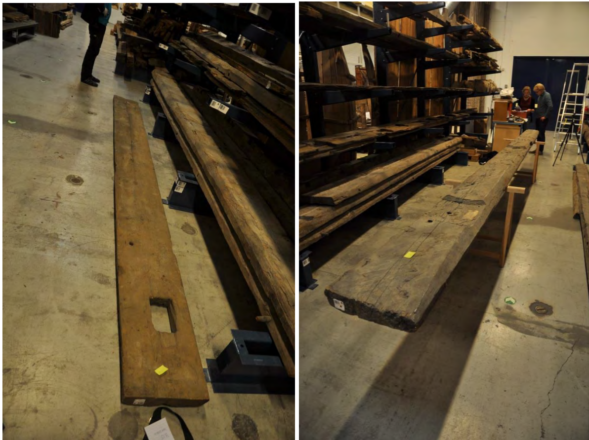
Till vänster exempel på en ovansida med ett inskuret kors, och till höger en undersida. Undersidan är grovt bearbetad med mycket vankant och har troligen aldrig varit avsedd att synas. Ett tecken på att de från början varit tänkta som golv.
