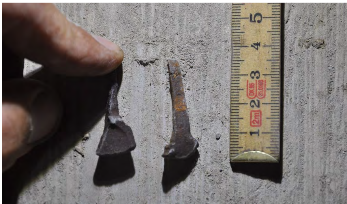
Till vänster hästkosöm från Knista, Örebro län. Till höger från Härad, Södermanlands län. Läggs märke till att den rektangulära klingan är olika ställd, i förhållande till huvudet på de båda.
