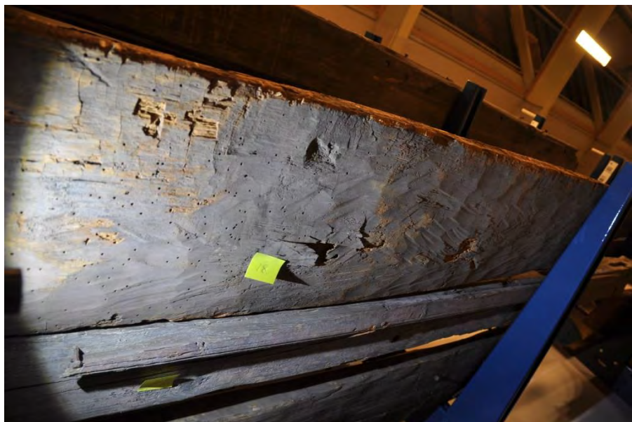
Ekplanka med sprätthuggning i lite varierande riktning.
