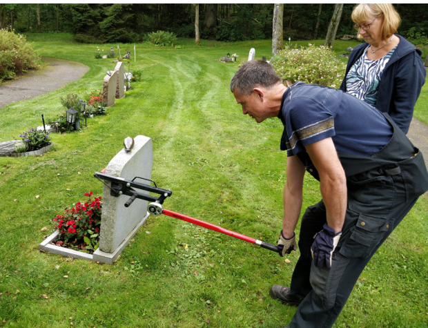
Ingemar Svensson och Yvonne Brynefelt-Axelsson kontrollerar att stenen står pall för 35 kg tryckbelastning. Redskapet är speciellt framtaget för att kontrollera gravstenar.
