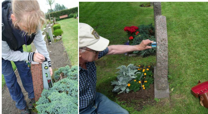
Figur 4. Kontroll av lutning med vinkelindikator.
