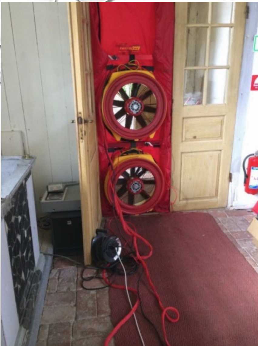
Läckagemätning i Holms kyrka. Stort luftläckage p.g.a. "rörliga" fönster.
