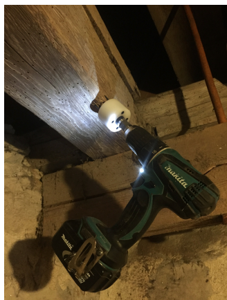
Borrning av prov nr 16 i den västra ekbjälken vid tornets murkrön.
