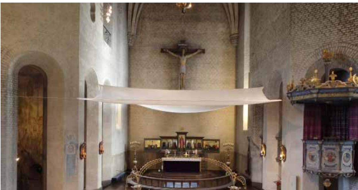
Ett nät skyddar koret från fallande stenar från taket.
