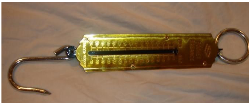
Figur 8. Exempel på fjädervåg. Denna går till max 75 kg (750 N).
