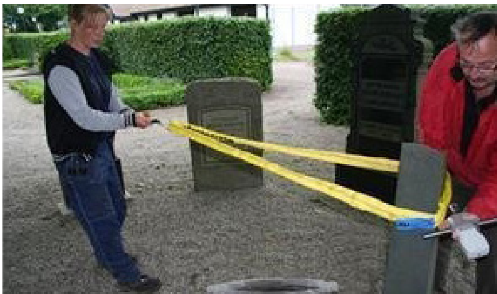
Figur 7. Belastningstest med fjädervåg, lyftstroppslinga och fender, här i form av bildäck.
