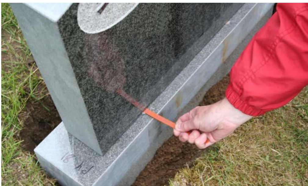
Figur 6. Kontroll av antalet dubbar med bågfilmsblad.
