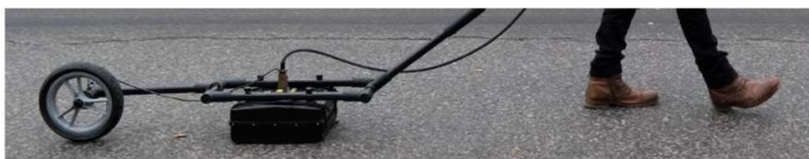
Figur 2-2 System trailer till GSSI antenna använd för att undersöka mellan kyrkbänkarna
