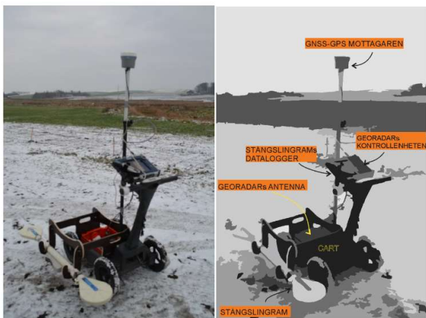
Figur 2-1. Cart (Vagn) med monterad Georadar, använd för att undersöka under mittskepp och utanför kyrkan
