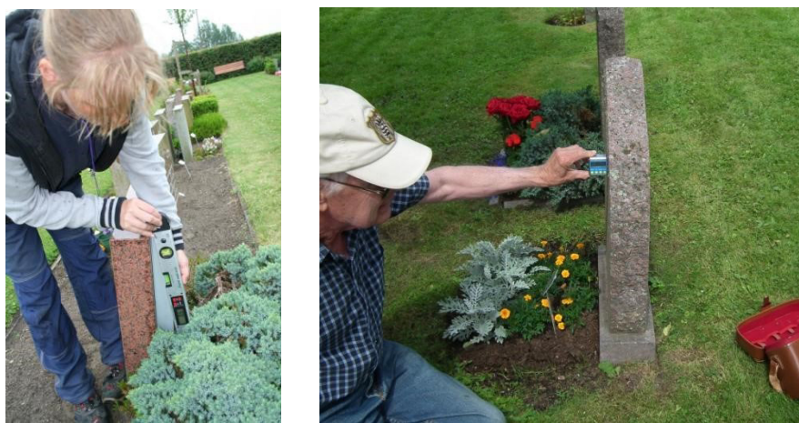
Figur 14. Kontroll av lutning med vinkelindikatorer.
