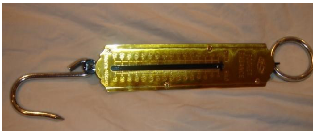
Figur 8. Exempel på fjädervåg. Denna går till max 75 kg (750 N).
