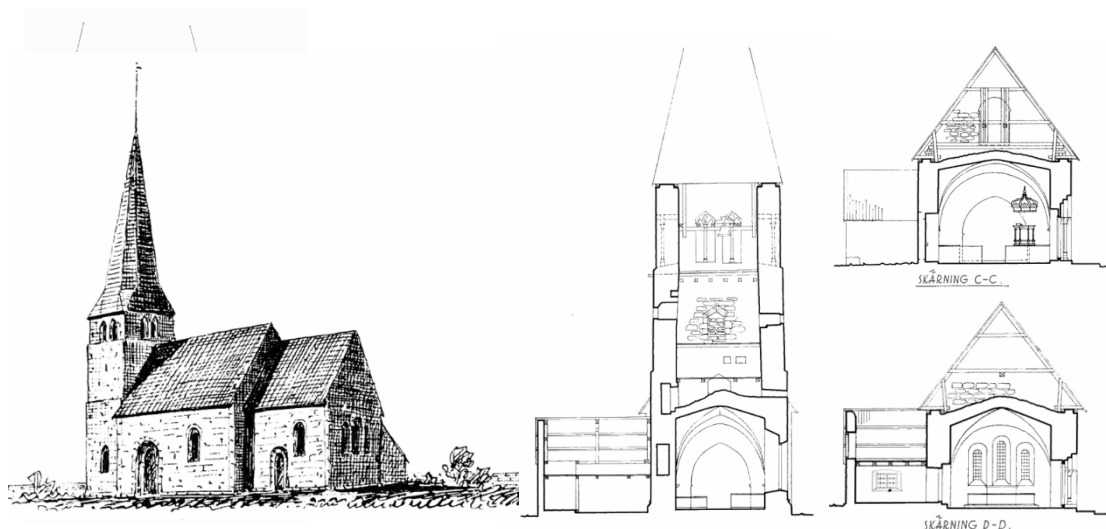
Tornets östra fasad med avtryck av långhusets tidigare takresning. I mitten sektion genom tornet och magasinet mot öster. Till höger sektioner genom långhuset respektive koret mot öster. Uppmätningar John Söderberg 1943, reviderade 1972. Efter Sveriges Kyrkor 156, Gotland VI:6 (1974).
