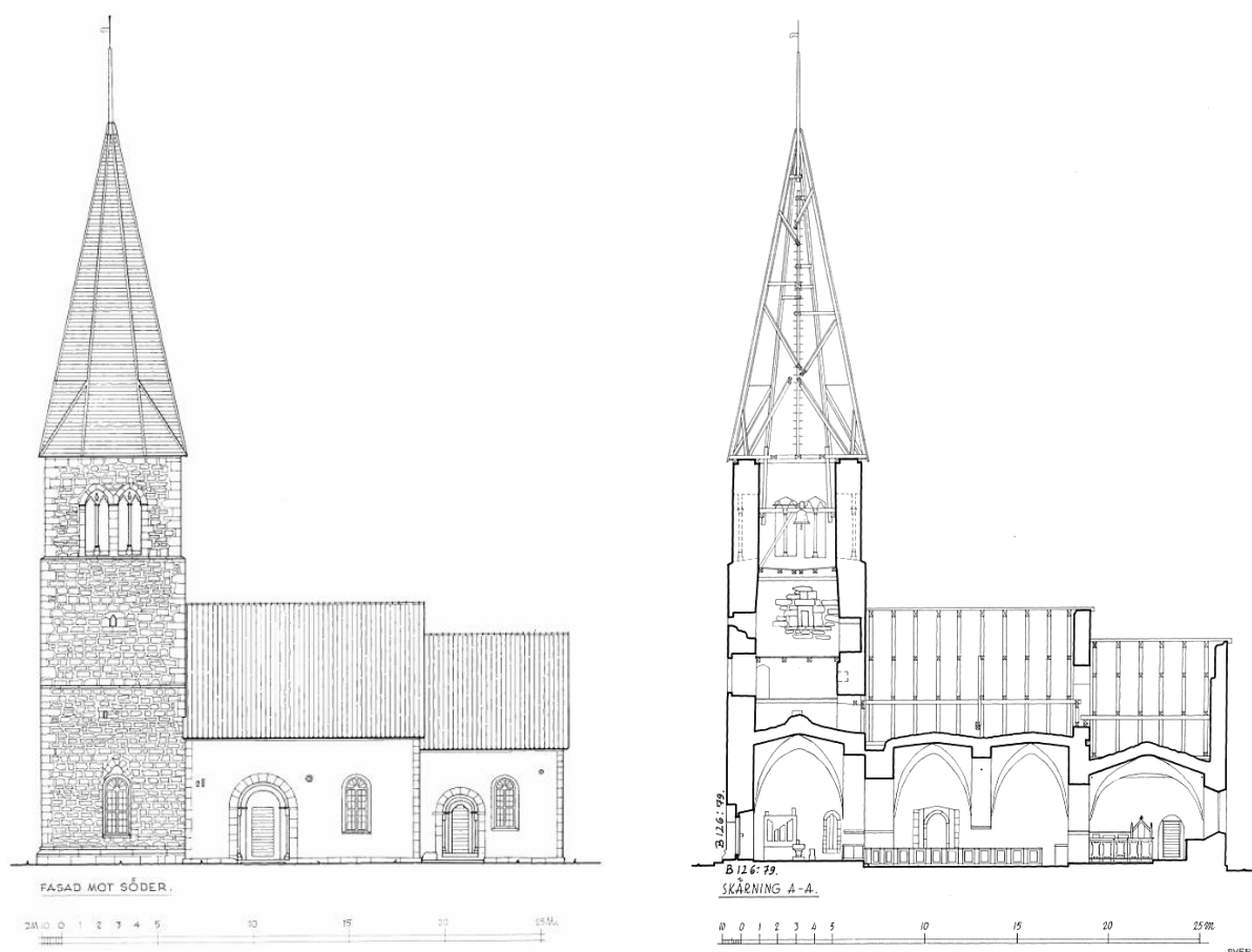
Fasad mot söder och längdsektion mot norr. Uppmätning John Söderberg 1967 respektive 1943, reviderad 1972. Efter Sveriges Kyrkor 156, Gotland VI:6 (1974), respektive ATA. Tornets fasader putsades 1969-1971.
