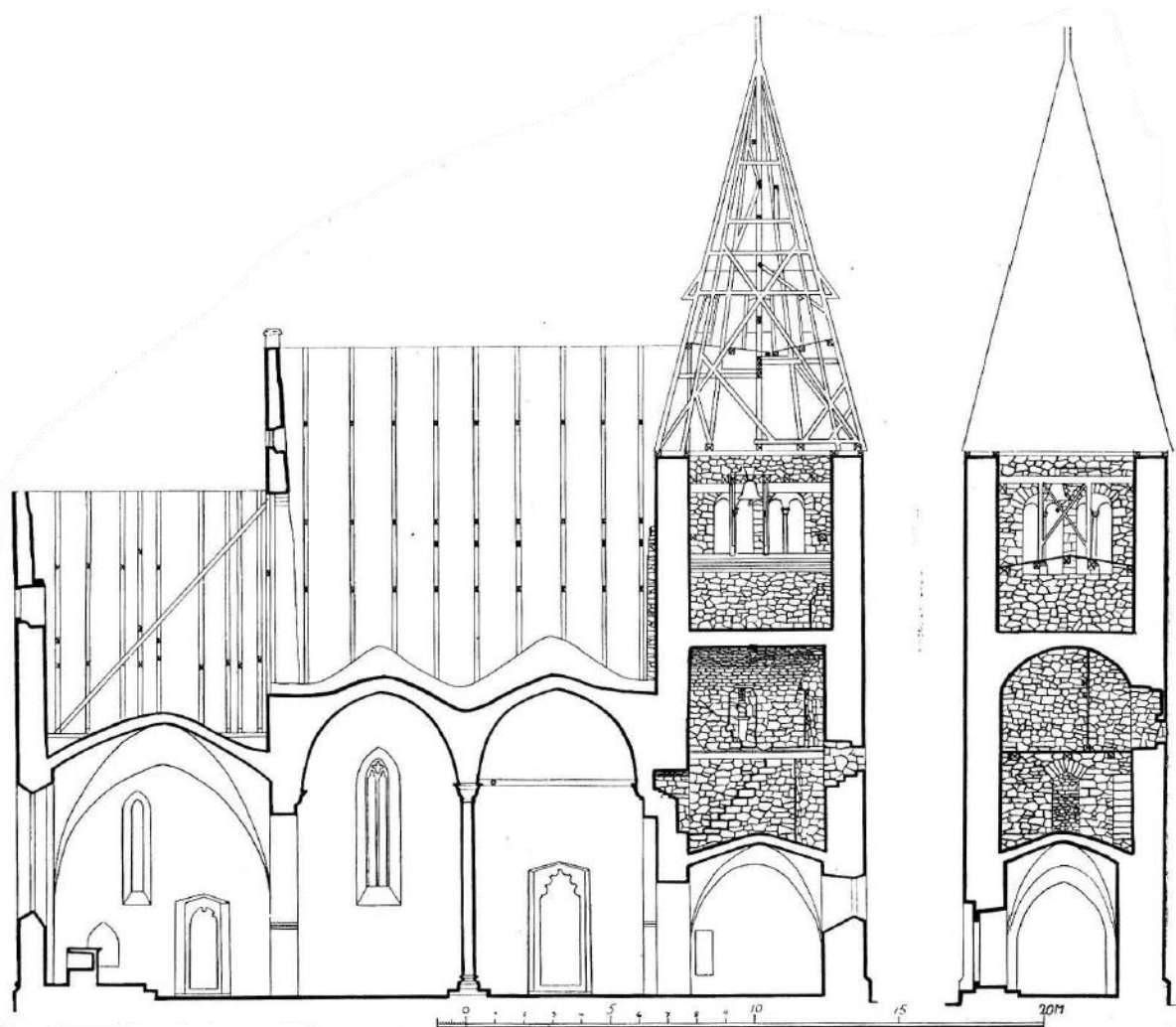
Längdsektion mot söder samt sektion av tornet mot öster. Uppmätning från 1940-talet. Tunnvalvet i tornsektionen till höger har lägre belägna anfang och är spetsbågigt, inte flackt rundbågigt. Tillträde till vinden sker genom ljudgluggarna. Efter Sveriges Kyrkor, Gotland IV:1, volym 61.
