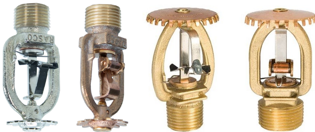
Figur 23 Reliable GFR Series med smältlänk ("Quick response") och Reliable G Series med en cylindrisk termisk känselkropp ("Standard response") samt Tyco Series TY-FRL med smältlänk ("Quick response") och Tyco Series TY-L med en cylindrisk termisk känselkropp ("Standard response"). Foton: Respektive tillverkare.
