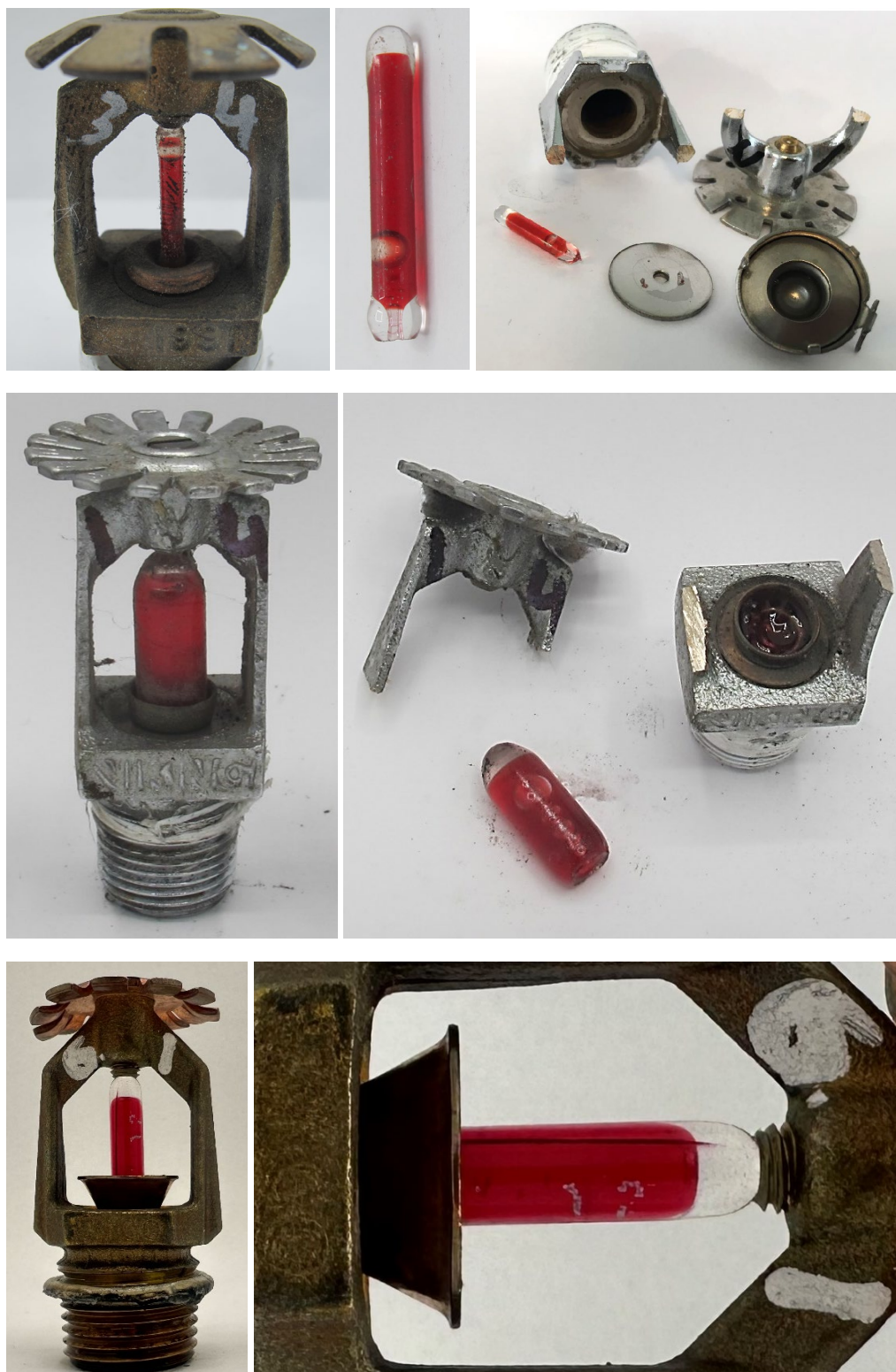
Figur 22 Två exempel på sprinkler med 3 mm glasbulb och ett exempel på sprinkler med 8 mm glasbulb där dess ena ände skadats. Det sista fallet är troligen ett tillverkningsfel där glasbulben monterats snett och skadats. Skadan är svår att upptäcka när sprinklern är installerad och gör att den inte aktiveras vid en brand. Det fjärde exemplet är en sprinkler med 5 mm glasbulb som utsatts för en mekanisk skada (spridarplattan är deformerad) som även skadat glasbulben. Foto: Mourhaf Jandali och Andreas Herbertsson, RISE.
