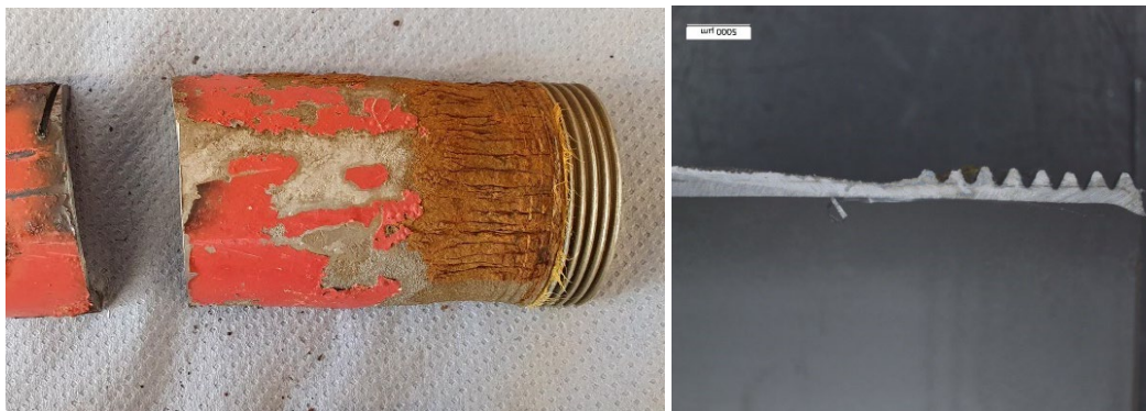
Figur 38 Utvändigt målade rör som har kraftig korrosion från utsidan. Rören i fråga hade suttit i en högkorrosiv inomhusmiljö med mycket fukt och klorider. Skadeområdena var främst lokaliserade nära gängorna vilket tyder på att den korrosionsskyddade färgen kan ha skadats i dessa områden. Till höger ett foto från granskning med mikroskop där det är tydligt att godset nästan är genomfrätt nära gängorna. Foto: Andreas Bergh, RISE
