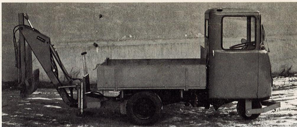
Allme trucken utrustad med grävaggregat, hytt, värme, breda hjul m.m.
