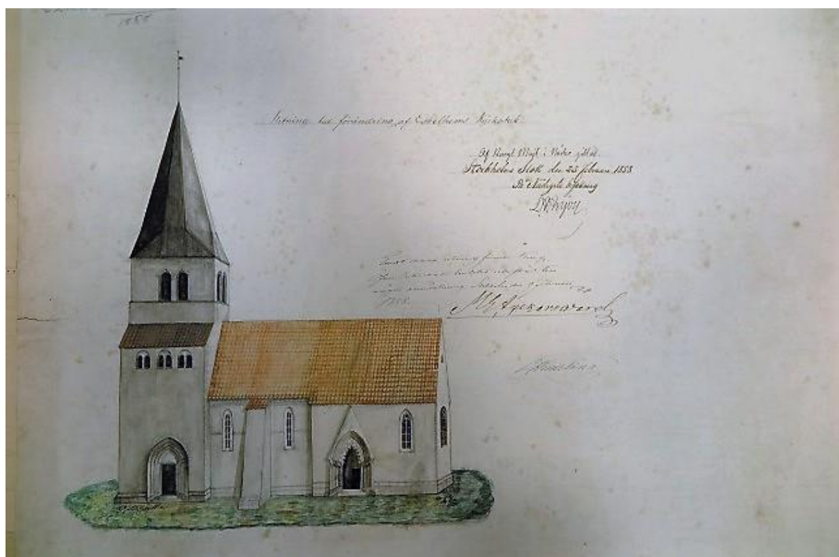
Ritningar till yttertakets förändring, gillad av Kungl. Maj:t 23/2 1858. Fasad och plan över kyrkans befintliga utseende samt förslag till ny takutformning. Förslaget utgick ifrån att strävpelaren skulle vara kvar. Landsarkivet i Visby, Eskelhems kyrkoarkiv, A 138-139.
