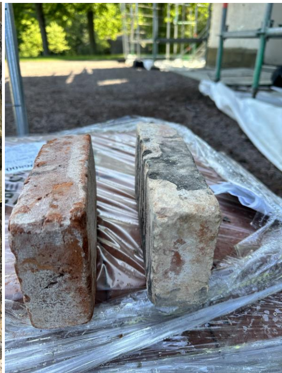
Sprickor och frostskador i teglets ytskikt, fogsläpp. Återanvänt tegel till kompletteringsarbetena.
