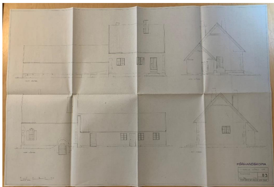
Slutligt förslag till om- och tillbyggnad. Ritning Per-Erik Nilsson utan år (1968 eller 1969), GMA. Fasader mot öster, söder, väster och norr.
