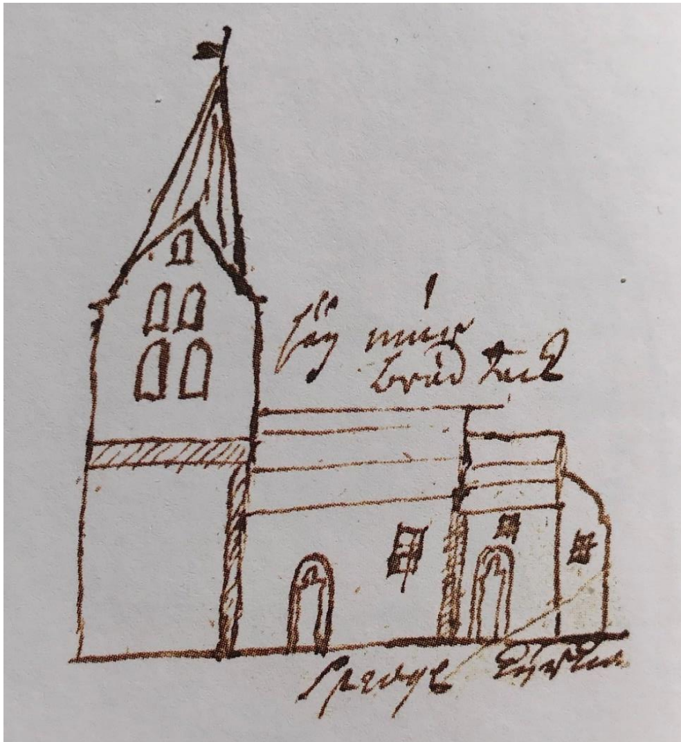
Exteriör från söder före 1839-40 års förändringar. Kyrkan täcktes av trätak och fönstren var rektangulära. Skrafferade partier anger större eller mindre språng i muren. Teckning av Johannes Pihl (?) ca 1726-30 för Analecta Gothlandensia . Efter Svensson 2008.
