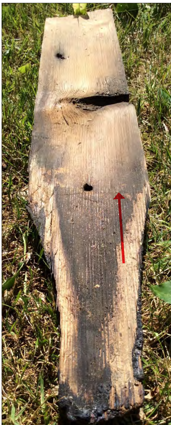
Figur 22. Rits för spik och/eller näbbformens start på baksidan av spånen. Spån från Kräcklinge klockstapel, Strängnäs stift. Foto Daniel Eriksson.
