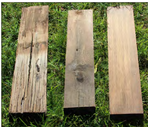
Möklinta klockstapel. Bleket på tre olika spån från 1900-talet som förekommer på klockstapelns. Till vänster ett bugget spån som troligen är samtida med de som lades på kyrkan 1931–32. Denna typ är dominerande på tak och fasader. Spånet i mitten är ett sågat spån sannolikt från 1953. Spånet till höger är kerosotspån eventuellt från 1982
