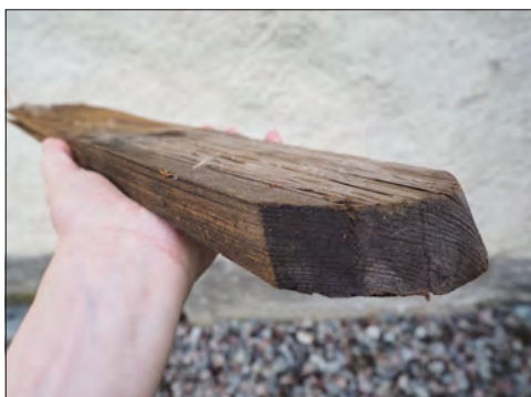
Kärro kyrka. Löst spån sett från basen.
