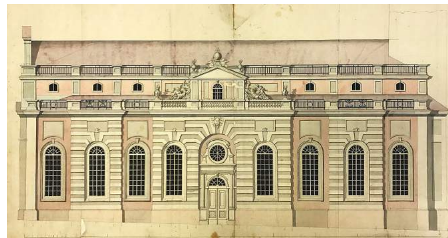
Ett tidigt förslag av Carlberg för norra fasaden åt slottet (troligen ca 1737). Carlberg avsåg att genom att förse långhuset med kraftfulla gavelmotiv ge intrycket av en korsaxel.
