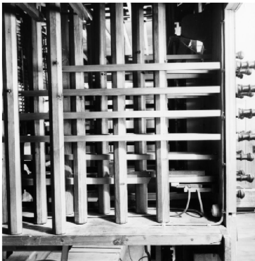
Registermekaniken i orgeln i Gammalkils kyrka från 1806. Foto: A. Unnerbäck.
