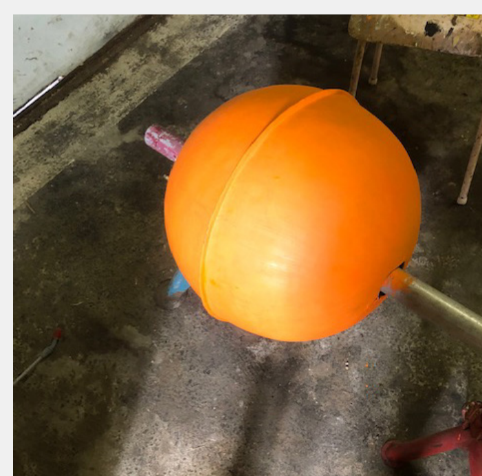
Efter noggrann rengöring följt av grundmålning med linoljebaserad blymönja.
