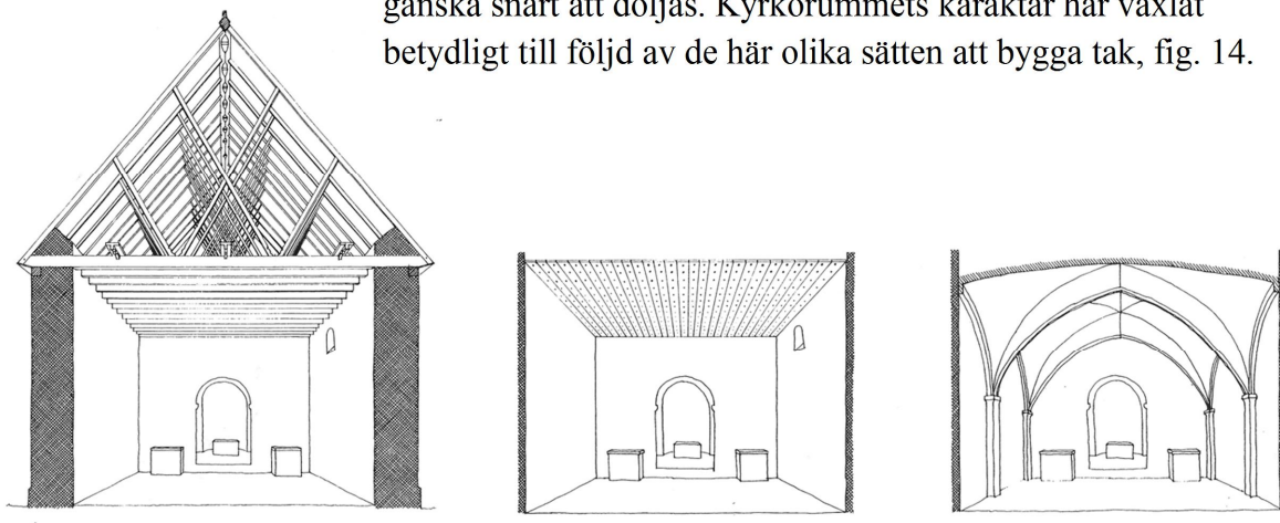
Figur 14 Kyrkorummets karaktär har präglats starkt av rummets avslutning uppåt. Under tidig medeltid var taket öppet, senare spikades brädtag mot takstolarna och efter ytterligare en tid byggdes valv in. Rekonstruktion av kyrkorummet i Hagebyhöga kyrka (Östergötland) under olika tidsperioder. Bild: Peter Sjömar.
