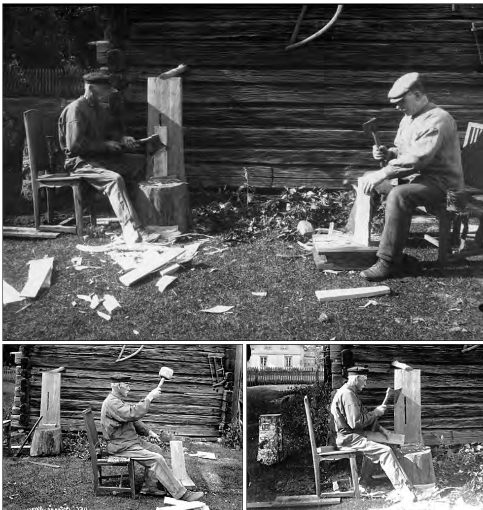
Figur 14–16. Bildsvit på spantillverkning. Bilderna är tagna 1924 av Sven T. Kjellberg och platsen är Östanäs i Nora socken i Uppland. Bildkälla Västmanlands läns museum, figur 14 neg. nr A-1155, figur 15 neg. nr A-1156, figur 16 neg. nr A-1157.
