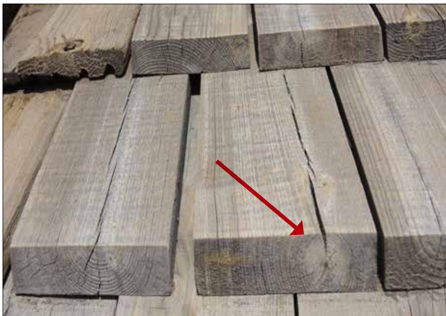
Det markerade stavspånet är en så kallad märgfångare eftersom märgen finns med i spånet. Aspeboda klockstapel, Västerås stift. Foto Sanna Srensson.
