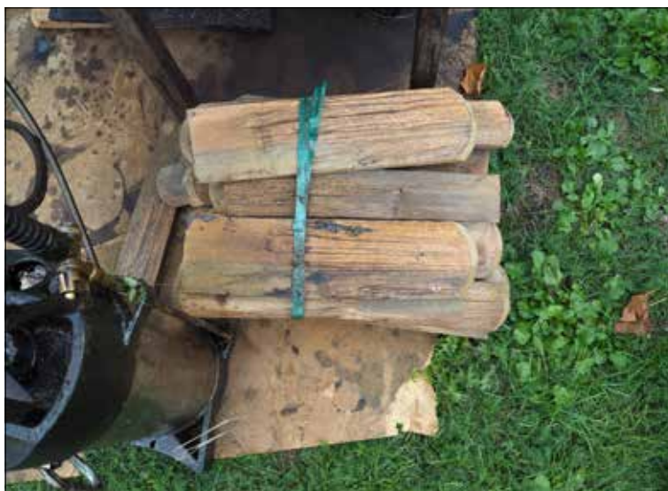
Ytterembörna kyrka. Bunt med lagnings- spån med stora delar splintved.
