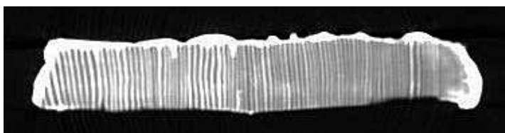
Figur 59. Tvärsnitt från skiktröntgen av Leksands-spånet. I bilden syns hela spånet i genomskärning, det vill säga om ett invändigt rötangrepp hade funnits någonstans längs med spånet så skulle det synas i bilden. I det ljusare partiet till vänster i bild syns att sommarveden haft en kraftig tillväxt. I röntgenbilden synliggjordes bland annat ytbehandlings tjocklek och inträngningsförmåga, att någon nedbrytning av skador i virket inte förekom samt att densiteten i virket är hög.
