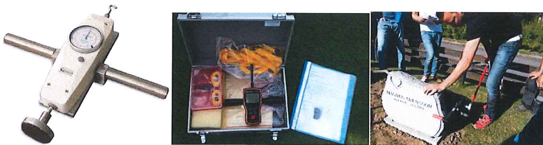
Figur 11. Tre gravstensinstrument. Till vänster FA-500 G från Elastocon AB, Brämhult, i mitten Sauturs instrument komplett i väska och med handledning på svenska, från SweTest, Saltsjö-Boo, Båda med tydlig display, tryckplatta och dragkrok och till höger det av Orax speciellt framtagna instrumentet för prövning av gravstenssäkerhet. Priset är ca SEK 4 000:- + moms (2013).
