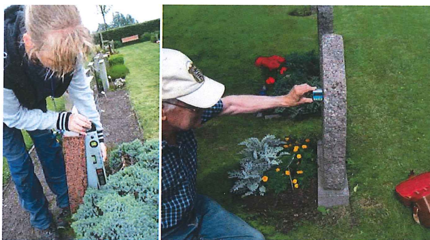
Figur 4. Kontroll av lutning med vinkelindikator.
