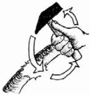
Ifrågasatt teknik. Några upplever att materialet flyter mera ut när man drar hammerslaget med sig i slaget. Dock finns det många små faktorer som spelar roll i detta.
