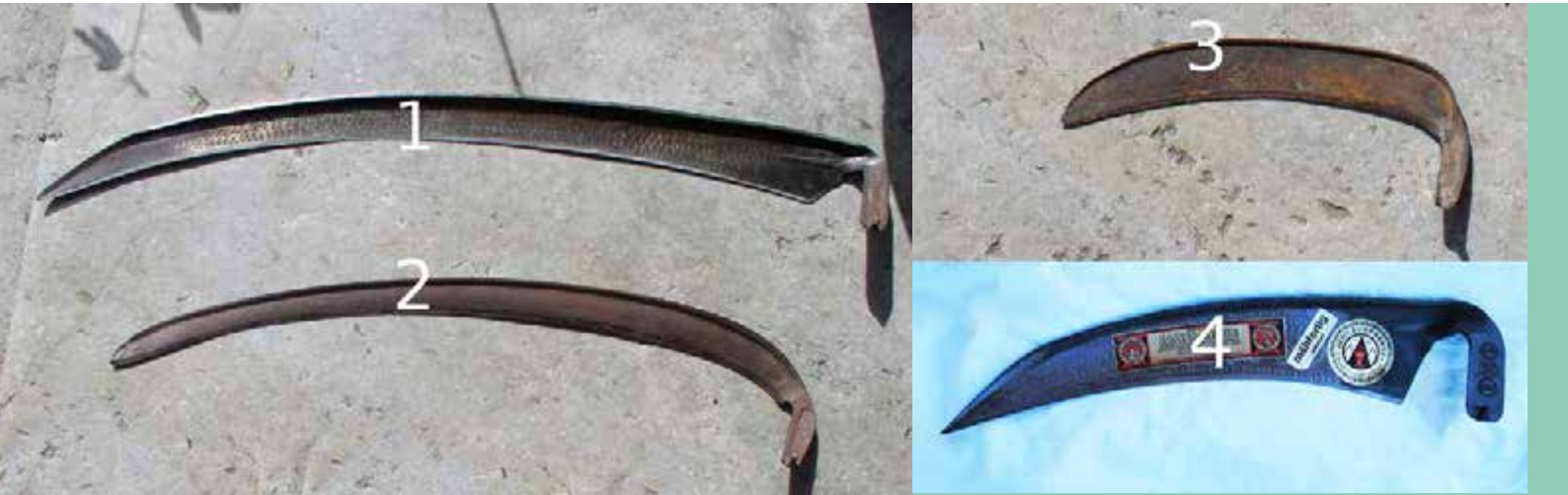
1. Knackelie för slätter. 2. Sliplie för slätter. 3. Sliplie för röjning. 4. Knackeblad för röjning
