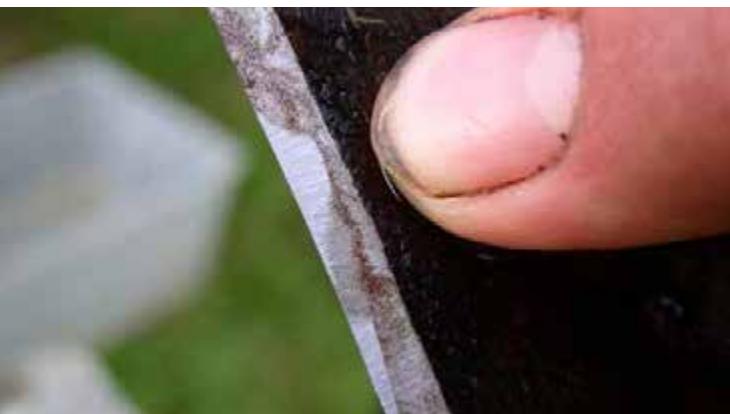
Efter en kort stund på slipsten ser man hur bra vinkel man hållit. Här har man slipat hela vägen ut över eggen, men innersta delen av fasen har inte sliipats alls. Vinkeln bör ändras så att både eggen och hela fasen slipas.
