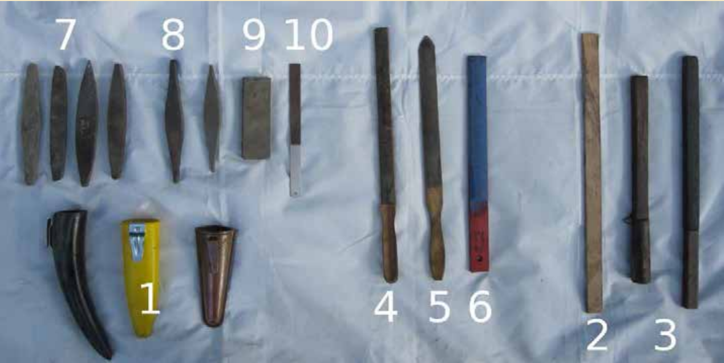
1. Brynehållare med vatten. 2,3. Vispestickor. Från vänster: En obehandlad, en med slippasta på, en med läder (också kallat strigel) 4,5,6. Brynestickor. Den blåa är för grov för det mesta. 7. Brynen i natursten. 8,9. Brynen i syntet. 10. Diamantbryne.
