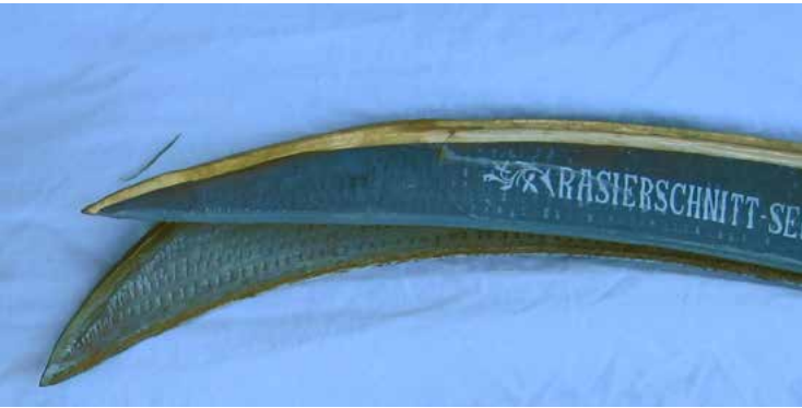
Två knackeblad lagda ovanpå varandra. Det kan vara stor skillnad i graden av krokighet.
