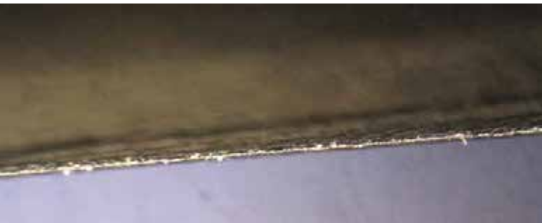
Förstoring av eggen. Ljusreflexioner visar att eggen är allt annat än fin och rak. Notera dock att en egg utan reflexioner också kan vara dålig.
