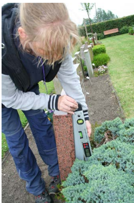
Figur 4. Kontroll av lutning med vinkelindikator.
