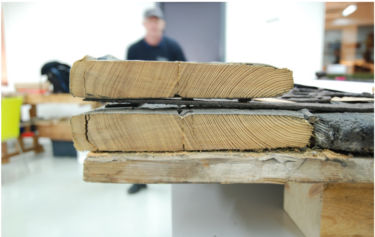
Bild 16: Samma ställe som bilden ovan, efter att nedersta delen sågats bort för dendrokronologisk analys. Materialet är tätvuxet, friskt kärnvirke av furu. I bakgrunden Hans Linderson.
