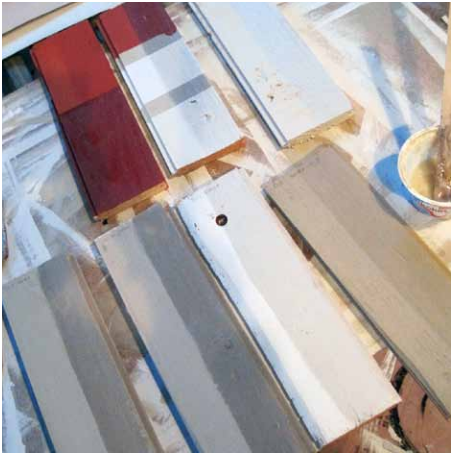
Mörka delen av provytorna är struken med en transparent limoljevax/vaxlasyr. Foto: Arja Källbom, 2011.
