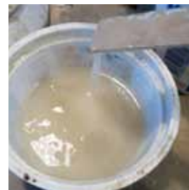
Slät kaseinlimolja 30/11 E, lika volymdelar ammoniumkasein och rå linolja. Den är lika fin efter en vecka, och luktar gott. Foto: Arja Källbom, 2011.
