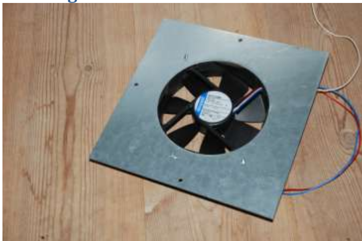
Fig 1: elfläkt monterad på plåtskiva som fästs i ventilationsgången.
