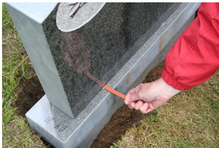
Figur 8. Kontroll av antalet dubbar med bågfilmsblad
