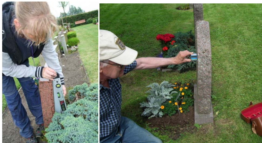
Figur 4. Kontroll av lutning med vinkelindikator.
