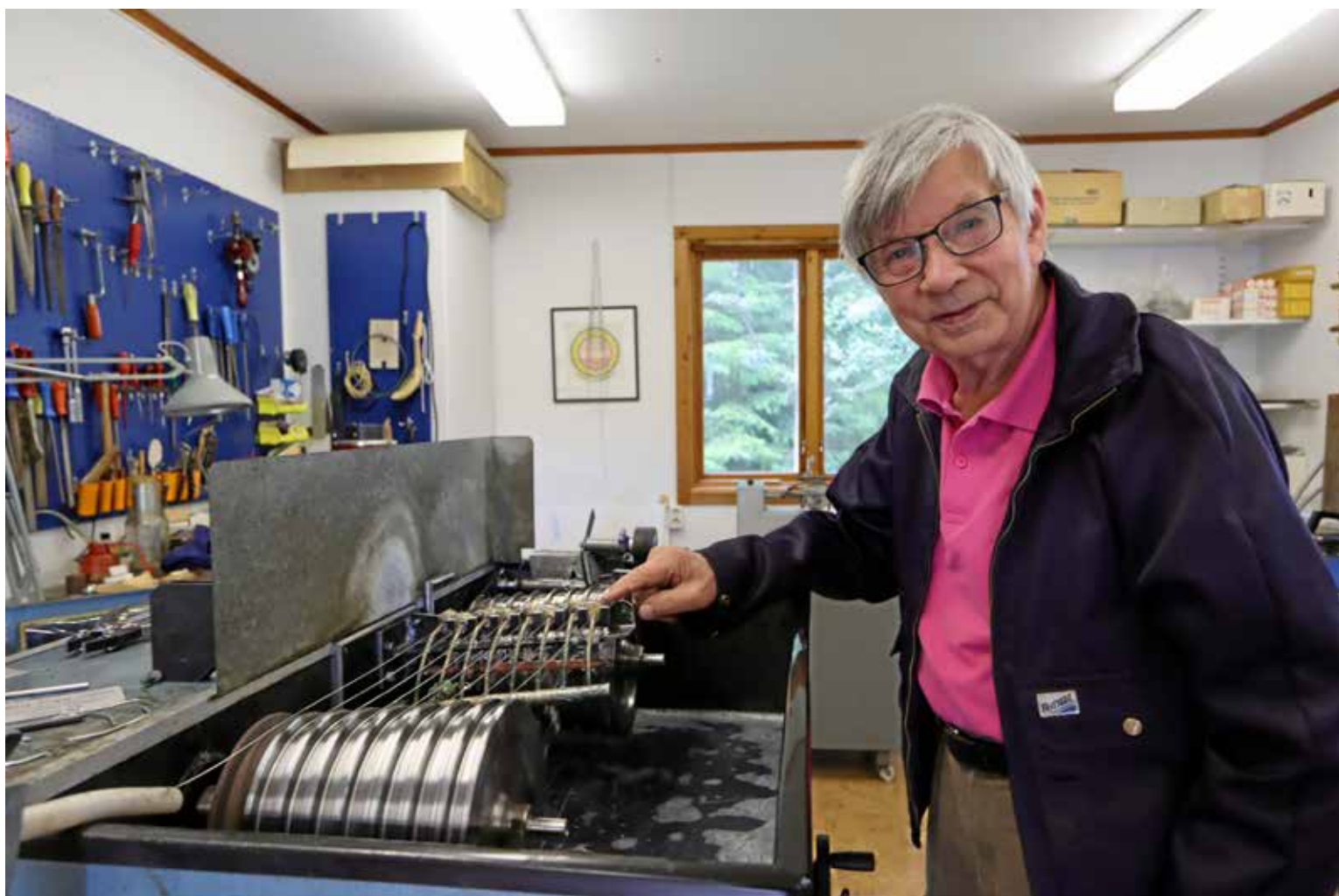
Tråddragningsmaskin är hjärtat i Lars Einars verkstad, här bubblar såpvattnen medan strängen av tenn tunnas ut till tråd.
